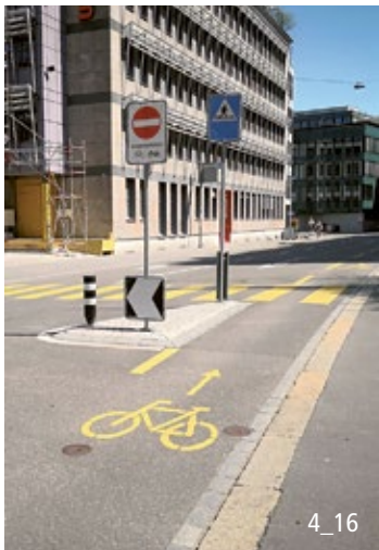
Trenninsel als Einfahrt in Einbahnstrasse in Gegenrichtung.
