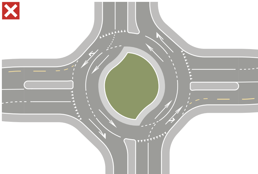
Abb. 631 Turbokreisel sind zu komplex, deren Befahrung auch für Motorfahrzeuglenkende anspruchsvoll und daher nicht veloverträglich
