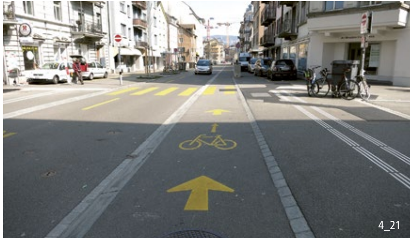
Vortrittsberechtigter Radweg in Kombination mit einer Trottoirüberfahrt.
